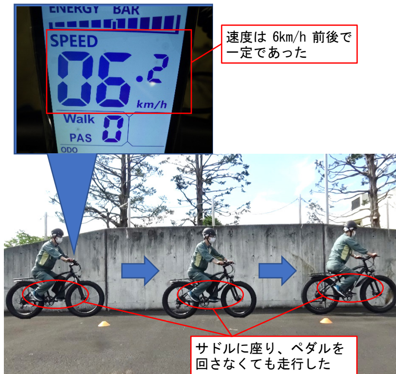
写真 3. 押し歩き機能に類似する機能による走行
