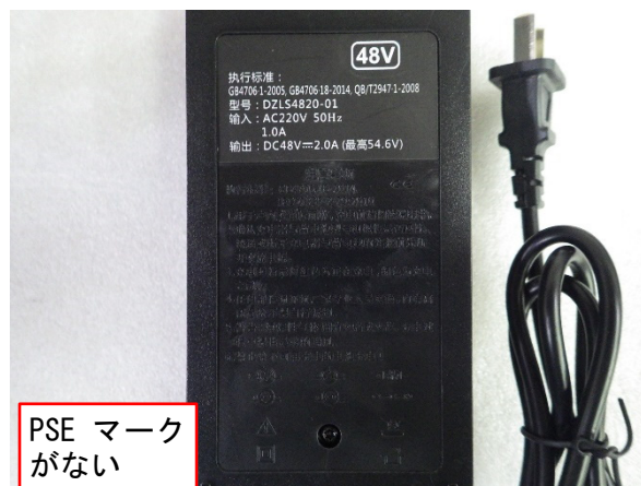
写真 6. PSE マークがない、もしくは表示が不十分であった一例 (No. 8)
