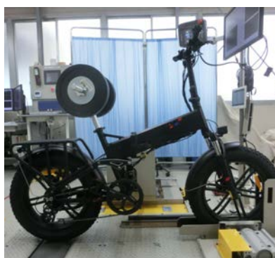
写真2. アシスト比率測定
