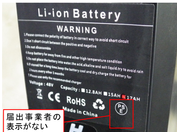
写真 6. PSE マークがない、もしくは表示が不十分であった一例 (No. 8)
